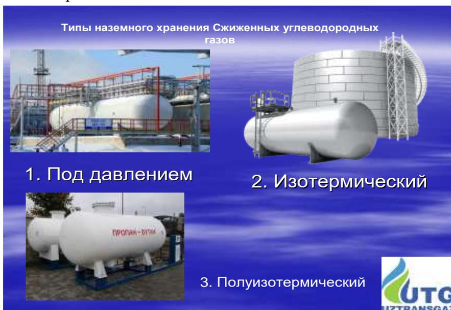
Рис.1. Типы резервуаров.
