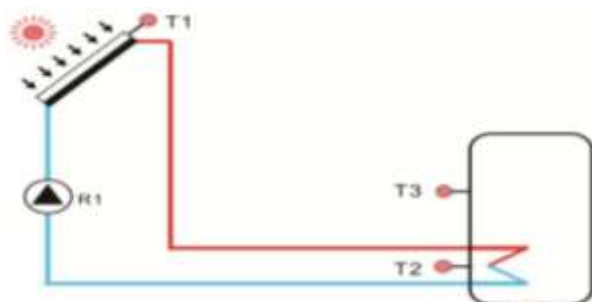
Рис.4. Структурная схема солнечного коллектора.
