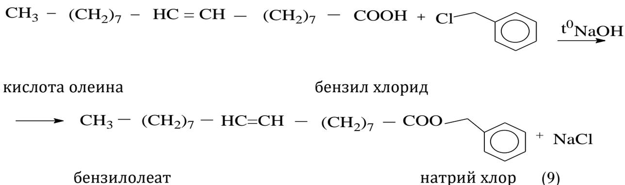
В этом процессе этерификации в качестве катализатора использовался NaOH. В этом случае свободные жирные кислоты первоначально вступают в реакцию с NaOH с образованием натриевой соли кислоты, а также воды. Тогда с полученной натриевой солью бензилхлорида механизм реакции будет выглядеть следующим образом:
