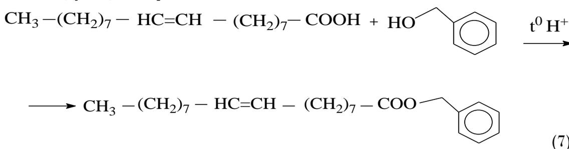
Проведение процессов этерификации в кислой среде позволяет получить сложный эфир, но в то же время продолжительность увеличивается, при этом, поскольку образующаяся среда является кислой, сложный эфир подвергается гидролизу, реакция обратима. Это может быть объяснено в формуле следующим образом:
