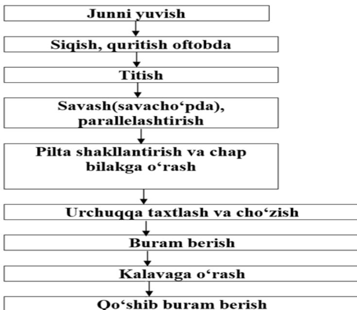
1-rasm. Tanda va arqoq iplarini tayyorlash jarayoni ketma ketligi.
