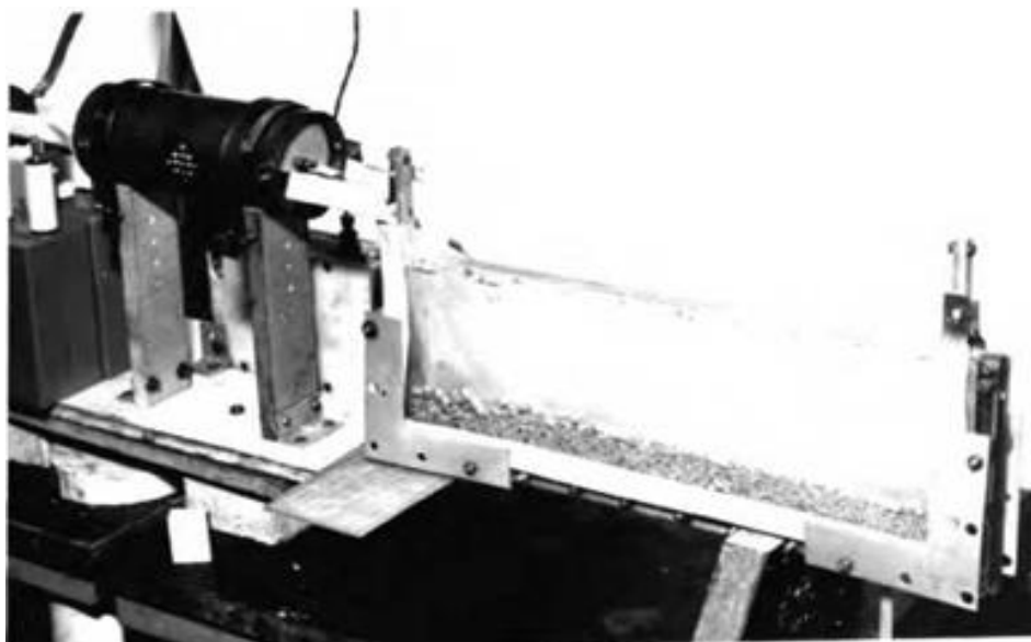
Внешний вид электроразрядного реактора с металлической загрузкой
