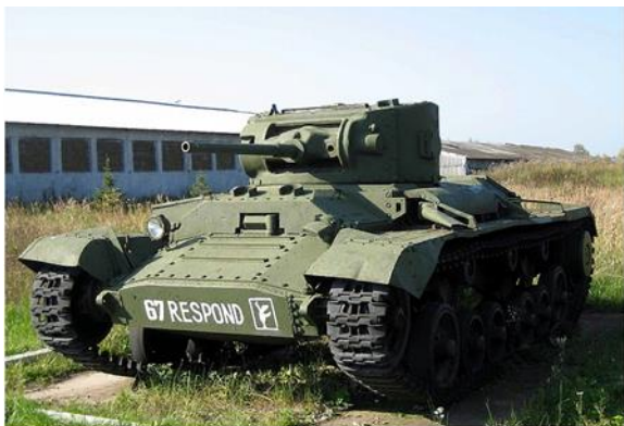
Рис. 21. Пехотный танк Mk.III «Валентайн». Великобритания, 1940 г.
