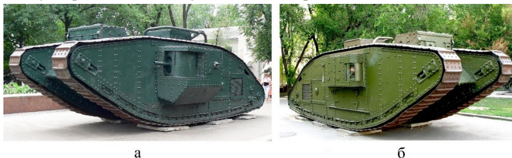
Рис. 9. Тяжелый танк «Mark I» (MkI) :а – «самец»; б – «самка»
