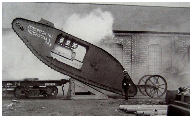
Рис. 8. Погрузка одного из первых танков Mk I на платформу.
