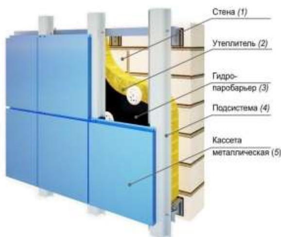
Рисунок 1 – Навесной вентилируемый фасад
