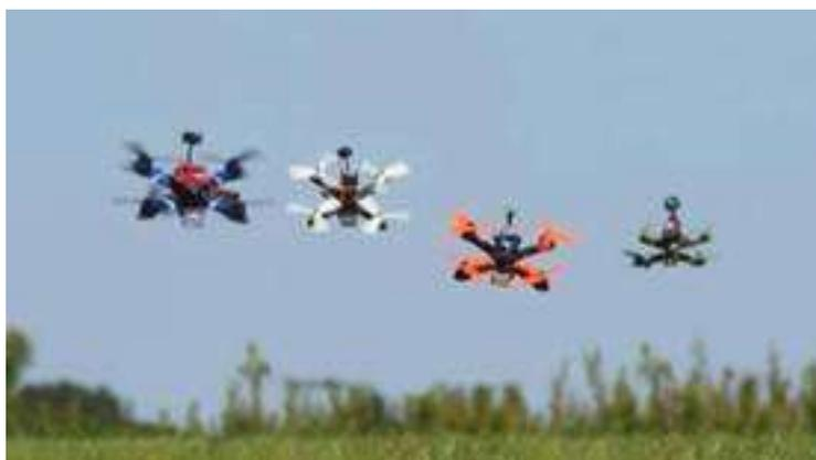
В дрон-рейсинге существует ограничение: расстояние между роторами диаметрально противоположных моторов не должно превышать установленного значения. Наиболее популярные классы дронов – от 210 до 250 мм. Количество моторов обычно не регламентируется, но почти все пилоты летают на квадрокоптерах – это оптимальное решение с точки зрения мощности, веса и аэродинамики. При этом время полёта гоночных дронов невелико и в среднем составляет 3–5 минут.
