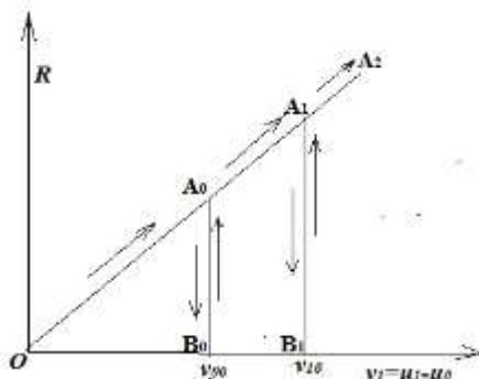
1-расм. Пойдевор нисбий қўчиши  $v_1 = u_1 - u_0$  билан таъсиrlанишув (реакция) кучи  $R$  орасидаги ўзаро боғланиш схемасининг график тасвири.
