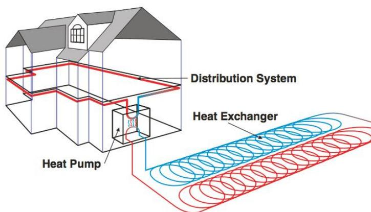
Горизонтальные установки с замкнутым контуром, как правило, наиболее эффективны с точки зрения затрат для небольших установок, особенно для нового строительства, где имеется достаточная земельная площадь. Эти установки включают закапывание труб в траншеи, вырытые с помощью экскаваторов или цепных траншеекопателей. В каждой траншее закапывают до шести труб, обычно соединенных параллельно, с минимальным расстоянием в фут между трубами и от десяти до пятнадцати футов между траншеями.
