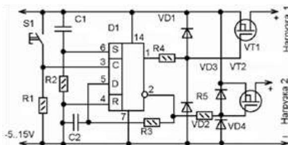
Рис. 2. Принципиальная схема электронного переключателя двух нагрузок.
