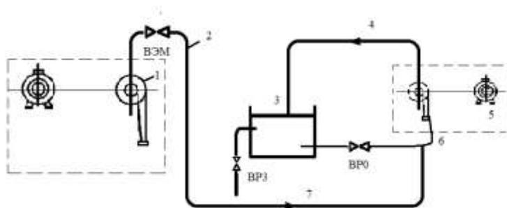
Рис.1. Функциональная схема заливки насосного агрегата с помощью вакуум-насоса.
