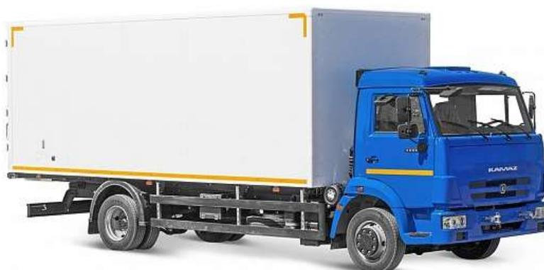
Автомобиль КамАЗ-4308 с изотермическим фургоном
