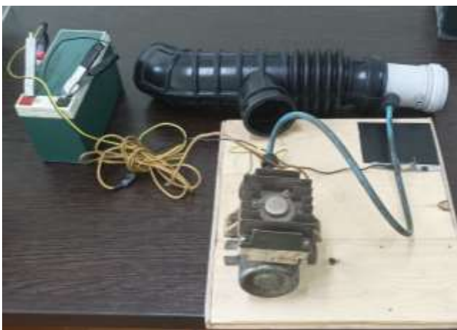
1- расм. Озонаторнинг тажриба намунаси
