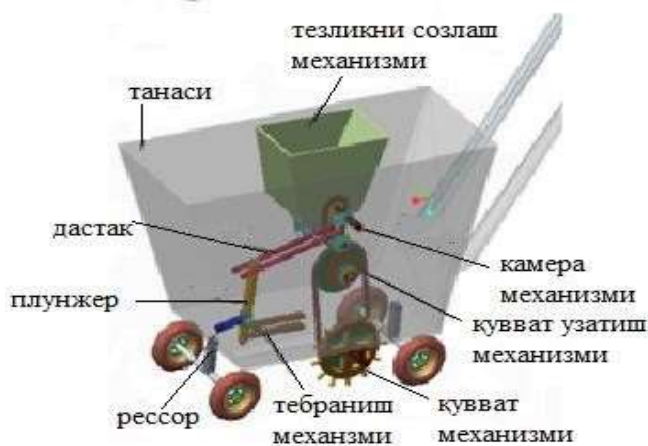
3-расм. Ишлаб чиқилган уруғ экиш сеяласи.1-тезликни созлаш механизми; 2-камера; 3-кувват узатиш механизми;4-тебраниш механзми; 5-рессор; 6-плунжер; 7-дастак; 8-танаси.
