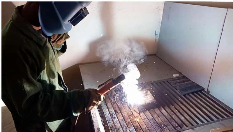
1-rasm. Pichoq va barmoqlarni payvandlash.
