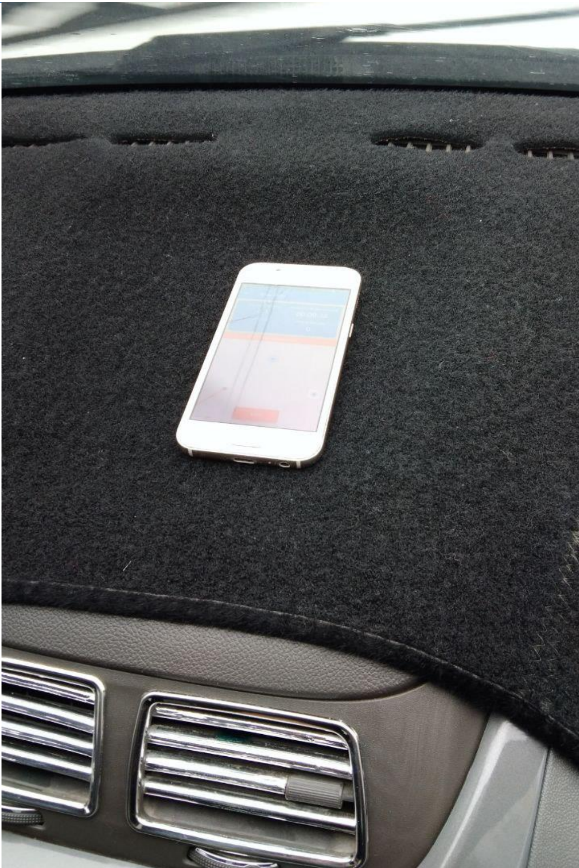
2- расм. Қурилмани ўрнатиш ва қоплама равонлигини ўлчаш жараёнлари
