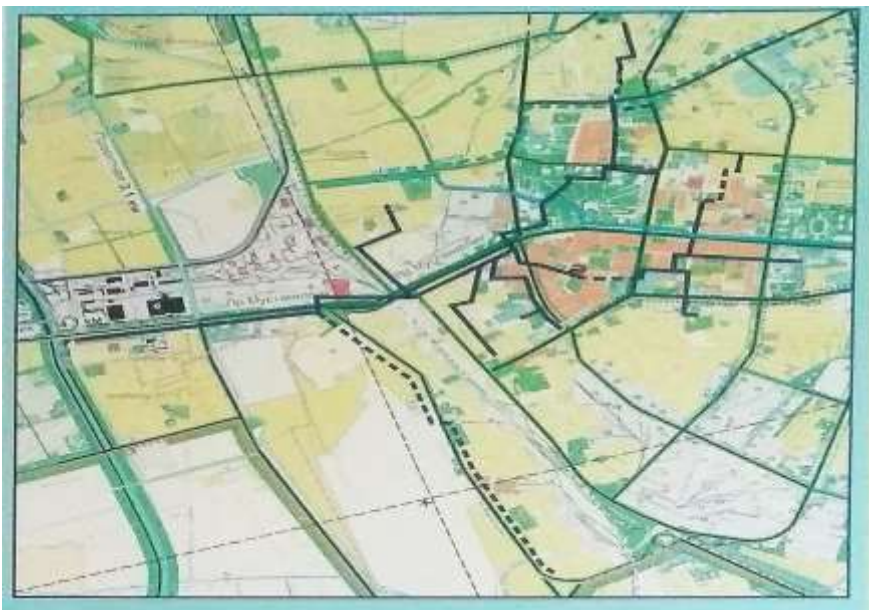
1-rasm: Nasaf(Yo'ldosh) nasos stansiyasi orqali Qarshi shahrini suv bilan ta'minlanish sxemasi.
