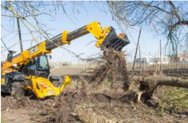
2-rasm.KP-3 teleskopik yuklagichga o'rnatilgan kundakov mashinasi.
