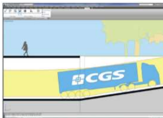
Рис. 14. Анализ траекторий движения транспортных средств в вертикальной плоскости
