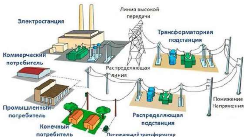
2- расм. Электр станциядан истеъмолчига электр энергиясини узатиш схемаси.
