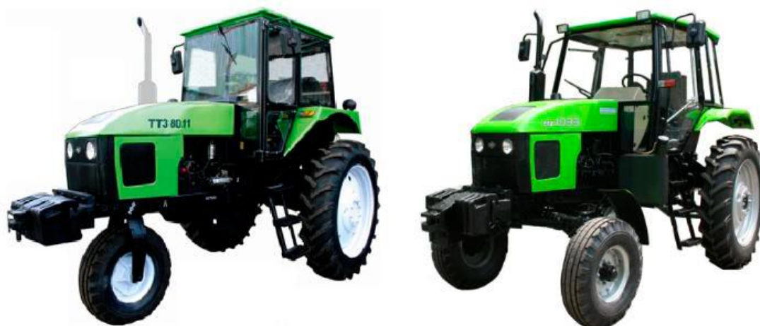
1-rasm. TTZ-80.11 g'ildirak formulasi 3K2 (a) va TTZ-1033 g'ildirak formulasi 4K2 (b) bo'lgan traktorlar.
