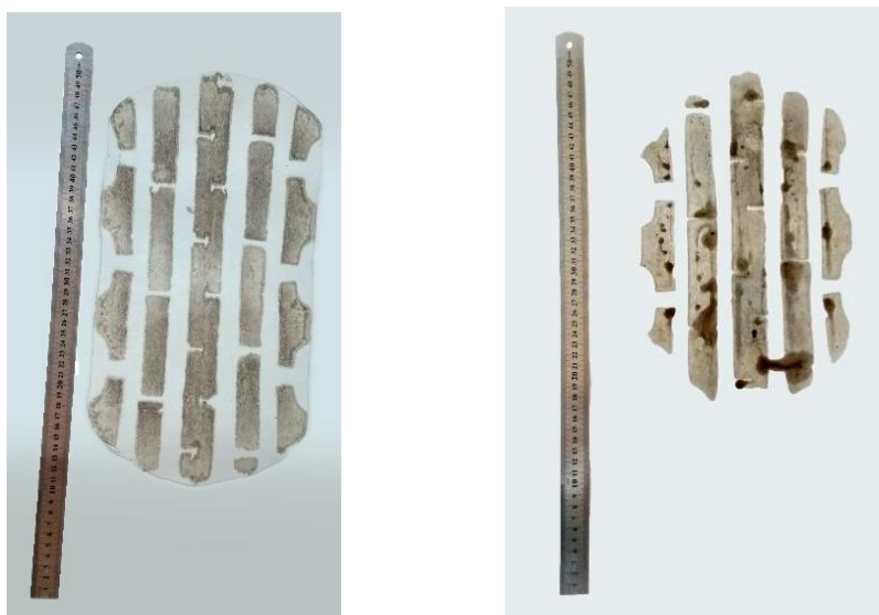
2-rasm. TTZ-811 (a) va TTZ-1033 traktorlari old g'ildiraklari shinalarining aloqa joylari turi.
