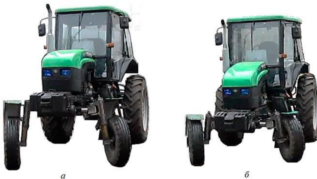
3-rasm. Takomillashtirilgan old klirens o'qi bilan jihozlangan traktor: a yuqori bo'shliq va b past bo'shliq.
