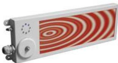
Серия оповещателей пожарных речевых и свето-речевых предназначена для оповещения людей о пожаре посредством предварительно записанного речевого сообщения и светового стробоскопического излучателя, относится к оповещателям активного типа. Оповещатель ТОЛМАЧ может применяться на открытых площадках, в неотапливаемых, частично отапливаемых и отапливаемых закрытых помещениях, а также во взрывоопасных зонах.
